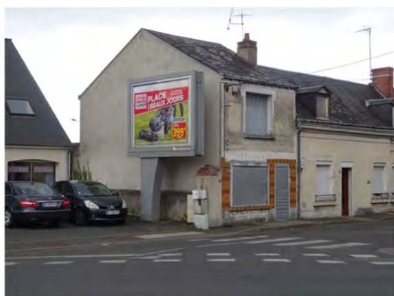
Publicité scellée au sol implantée à une distance inférieure à la moitié de la hauteur du dispositif (H/2) de la limite séparative
