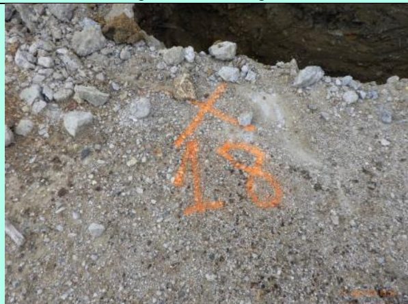
Sondage N° 18 – collecte d'échantillon positif à l'amiante
