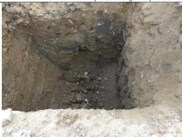
Sondage N°16 1,20m de 0/120 – 0,80m de terres 1,00m terres noires
