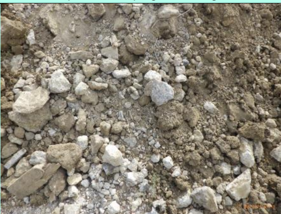
Détail du concassé et des terres extraites des sondages (absence de matériaux amiantés)
