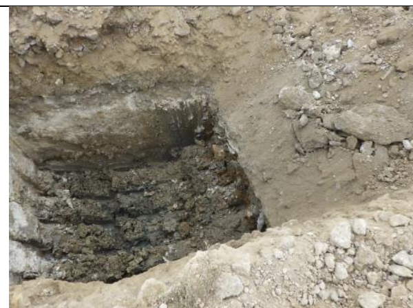
Sondage N°30 0,60m 0/120 – 1,00m de terres noires 1,40m de terres
