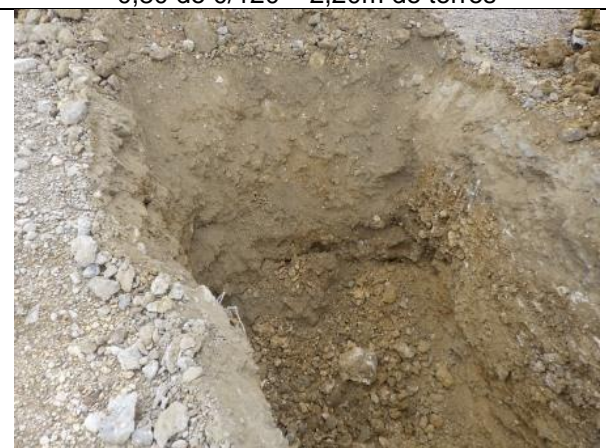
Sondage N°29 0,60m 0/120 – 2,40m de terres
