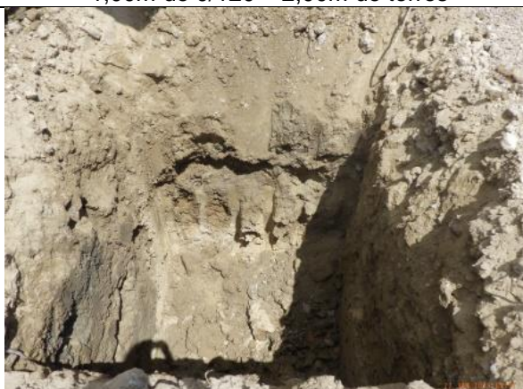
Sondage N°12 0,60m de 0/120 – 0,50m de terres noires 1,90m de terres
