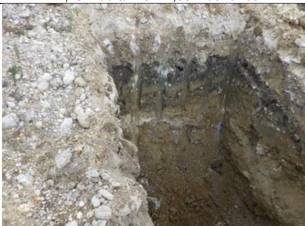
Sondage N°20 0,5m de 0/120 – 1,80m de terres 0,60m de terres noires
