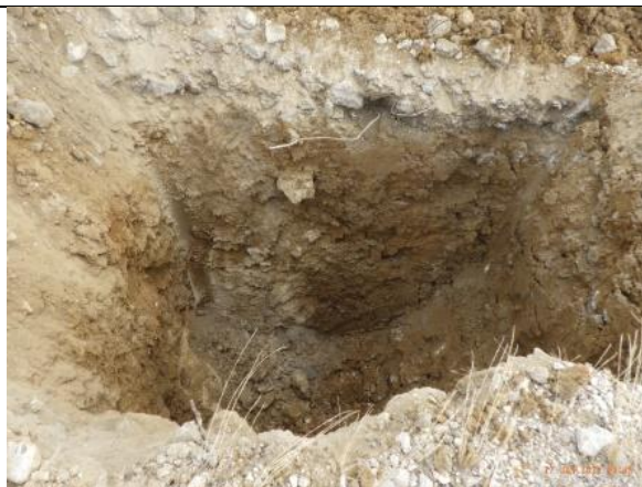
Sondage N°06 0,60m de 0/120 – 2,40m de terres
