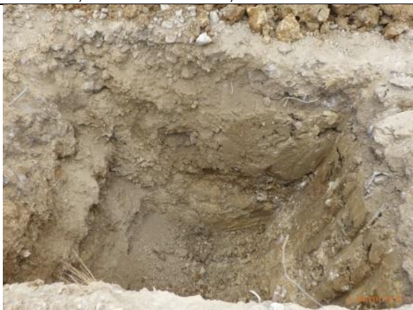
Sondage N°07 0,80m de 0/120 – 2,20m de terres
