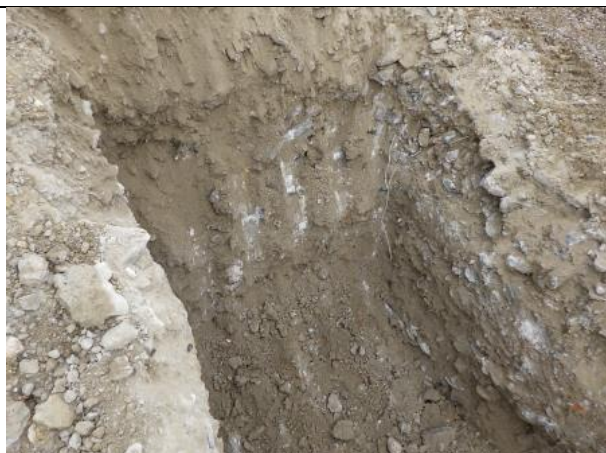
Sondage N°25 1,20m de 0/120 – 1,80m de terres
