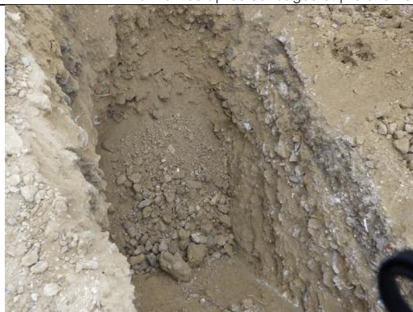
Sondage N°26 1,20m de 0/120 – 1,80m de terres
