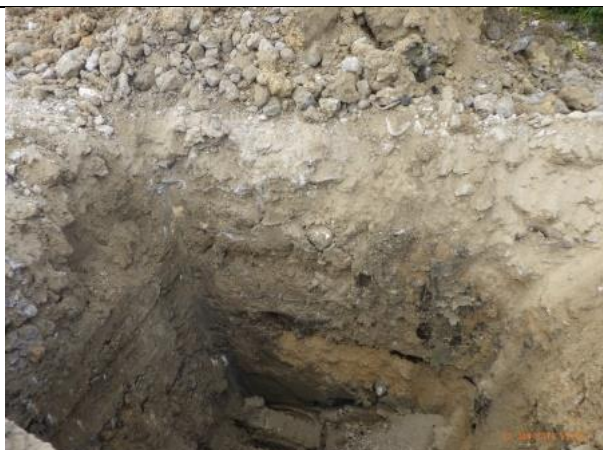
Sondage N°15 0,80m de 0/120 - 2,20m de terres
