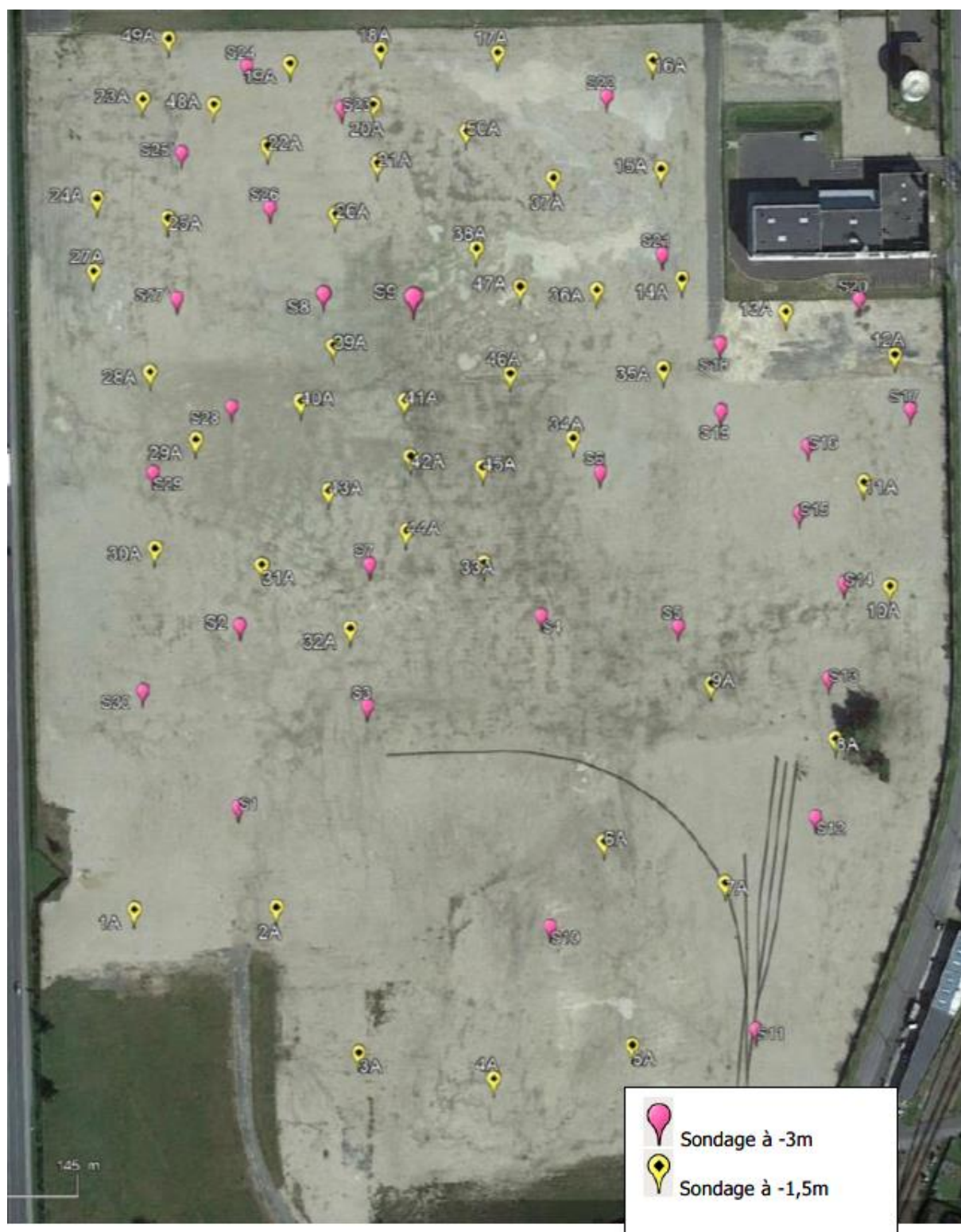
Figure 9 : plan de localisation des 80 sondages de sols entre 1,5 et 3 mètres de profondeur GINGER DELEO
