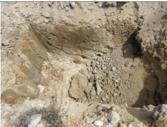
Sondage N°08 0,40m de 0/120 – 2,60m de terres
