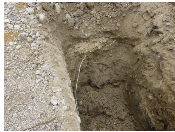
Sondage N°28 0,60m de 0/120 – 2,40m de terres
