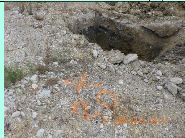
Sondage N° 20 – collecte d'échantillon positif à l'amiante
