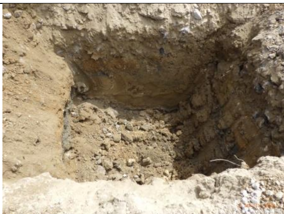
Sondage N°09 0,50m de 0/120 – 2,20m de terres
