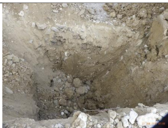
Sondage N°02 1,40m de 0/120 – 1,60m de terres
