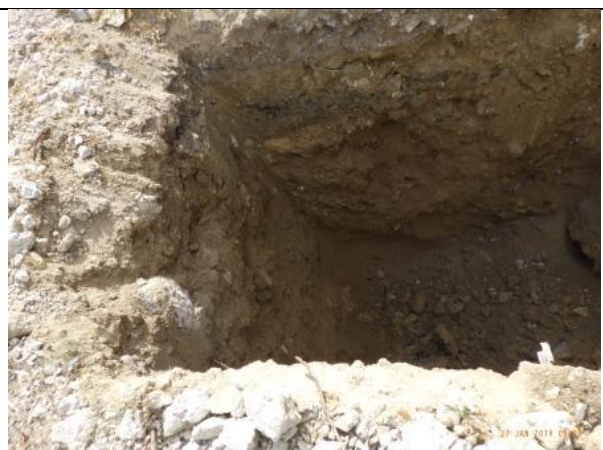
Sondage N°17 0,70m de 0/120 - 2,30m de terres
