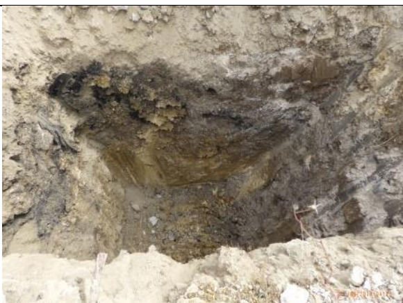
Sondage N°11 0,60m de 0/120 – 1,40m de terres noires 1,00m de terres
