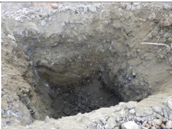
Sondage N°03 1,60m de 0/120 – 1,40m de terres
