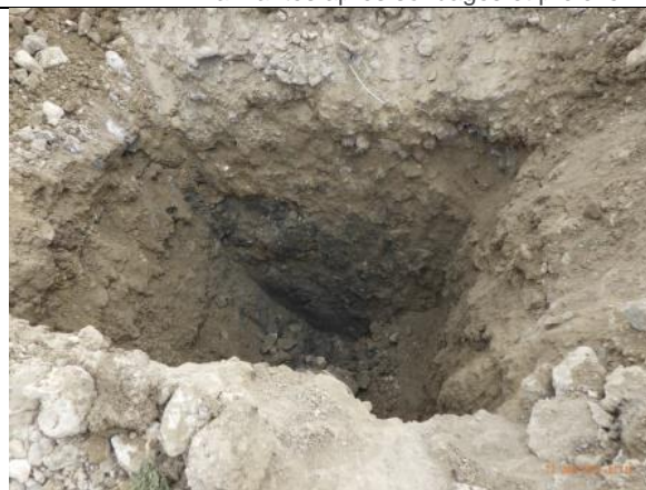
Sondage N°04 0,80m de 0/120 – 2,20m de terres
