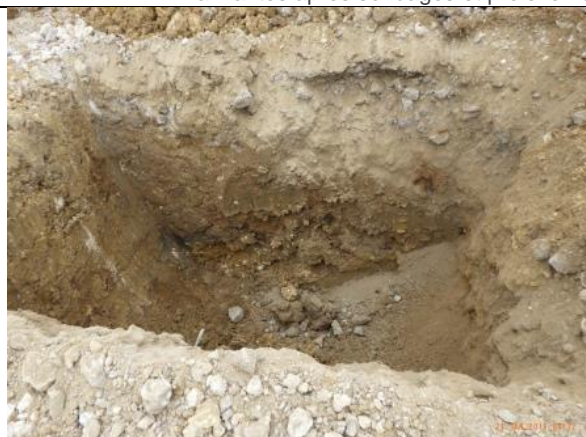
Sondage N°10 1,00m de 0/120 – 2,00m de terres
