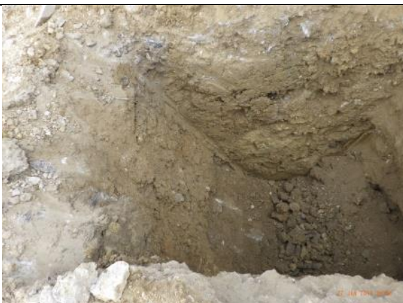
Sondage N°13 1,10m de 0/120 – 1,90m de terres
