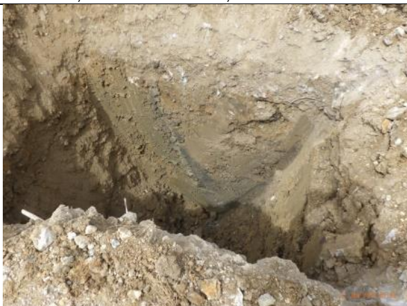
Sondage N°05 0,60m de 0/120 – 2,40m de terres
