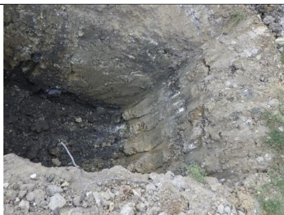
Sondage N°24 0,80m de 0/120 – 1,20m de terres noires 1,00m de terres
