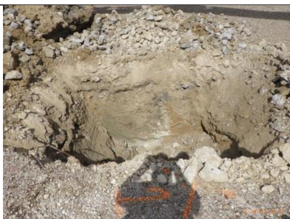
Sondage N°01 0,80m de remblais concassé 0/120 – 2,20m de terres
