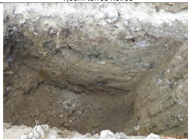
Sondage N°18 1,20m de 0/120 – 1,80m de terres
