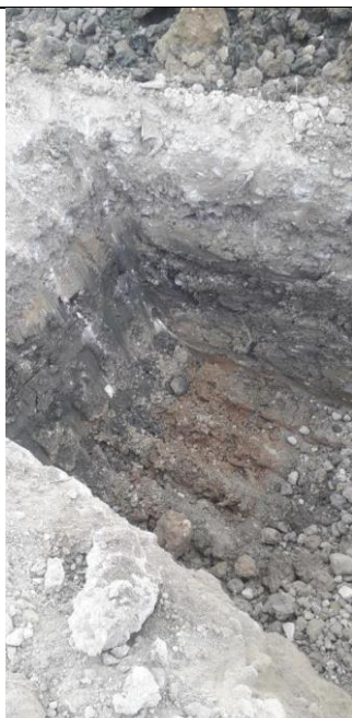
Sondage N°21 0,80m de 0/120 – 1,00m de terres noires 1,20m de terres
